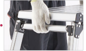
伸縮操作バー真ん中を引き上げれば2脚伸縮することができます
